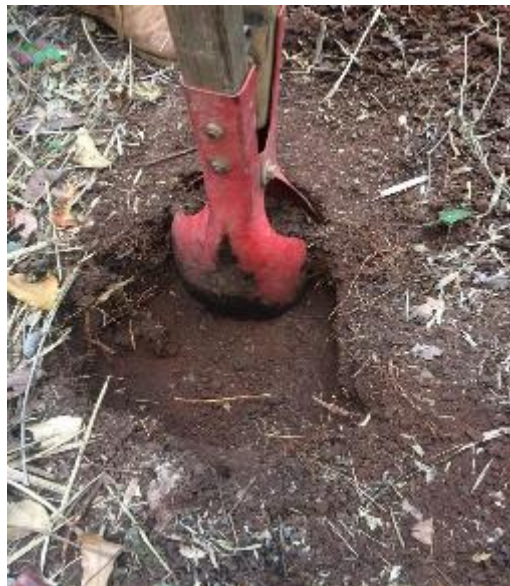
Foto 1- Coleta de amostra deformada com cavador manual.
