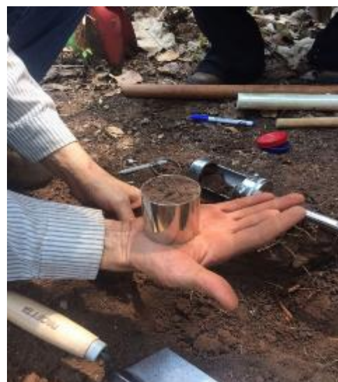
Foto 3- Coleta de amostra indeformada.
