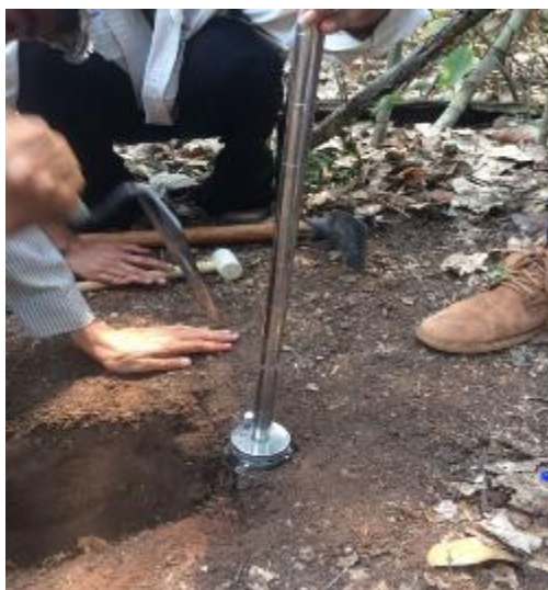
Foto 2- Trado de anel de aço (Kopecky) de bordas cortantes e volume interno de 50cm 3 .
